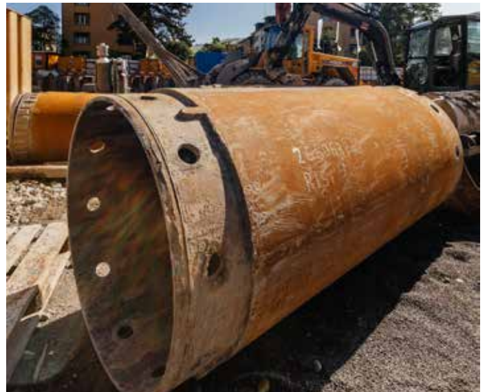
Bohrrohr für Grossbohrpfähle
